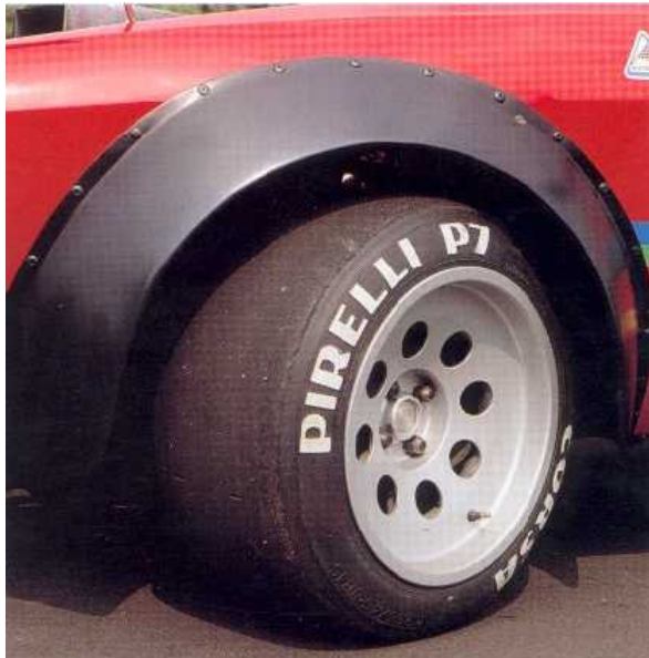
Klassische Alfa Romeo Felgen mit extrem breiten Pirellis an der Alfetta GTV Turbodelta Gr.4.
